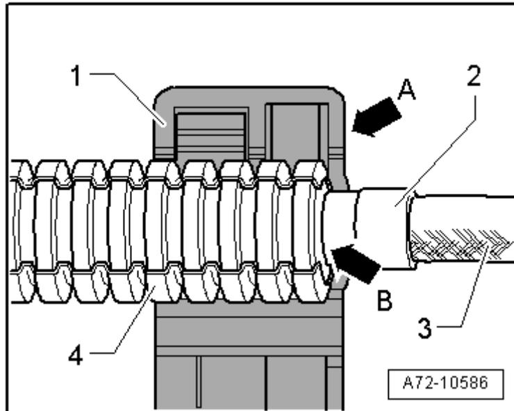
Envolver la transición entre el extremo del asiento del tubo ondulado -1- y el mazo de cables -2- con cinta textil autoadhesiva -flecha-.
